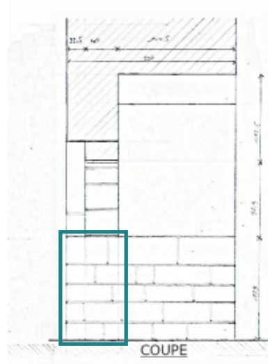
Coupe du piédroit nord-ouest et nord-est. En bleu, la zone d'intervention où les pierres seront refouillées puis remplacées par les nouvelles pierres des piédroits (dessin T. Schrauwen, 2021)
